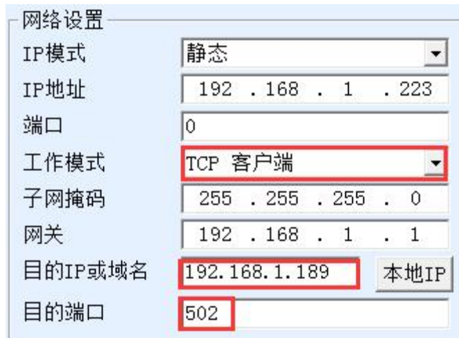
图 28 Modbus TCP 做客户端。
