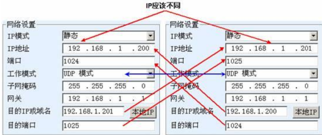
图 39UDP 设备对联参数配置
