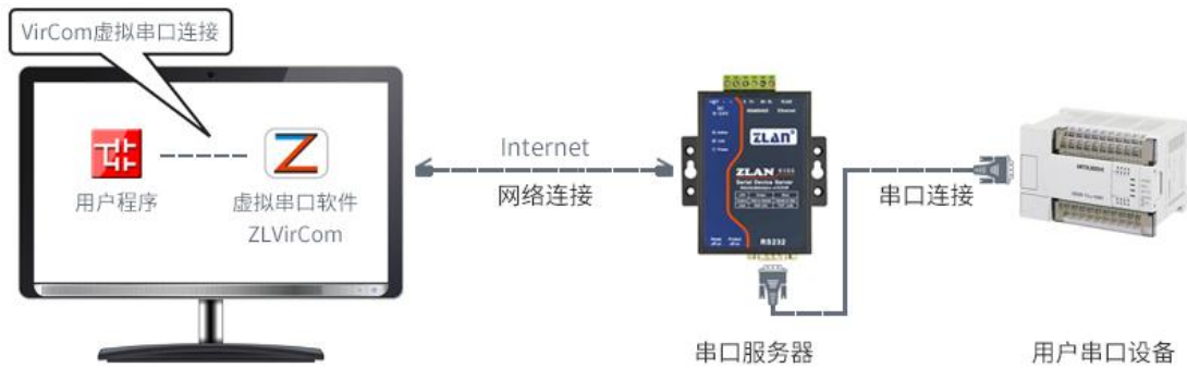
图 23 虚拟串口的作用
