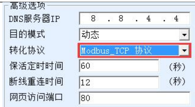
图 27 启用 Modbus TCP 功能
