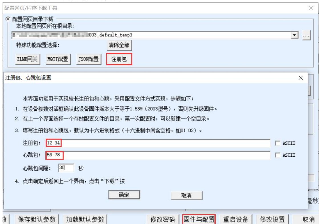
图 54 配置文件方式的心跳包注册包
